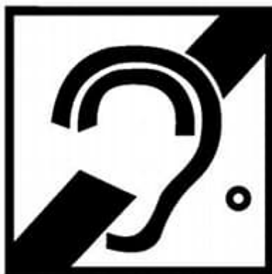
Рисунок 4 – Пиктограмма с символом индукционной петли
