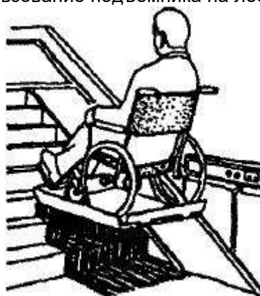
Использование подъемника на лестнице
